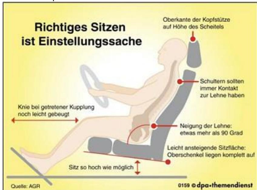
Die Pedale müssen sicher und leicht ganz durchgetreten werden können. Die Beine dürfen nicht durchgestreckt sein (sonst kann es durch die Kraftübertragung zu Bein- oder Hüftverletzungen auch bei leichten Unfällen).
